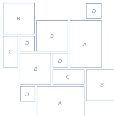
*Le calepinage ci-contre est réalisé à partir d'un module de 1,44 m<sup>2</sup> ou deux modules de 0,72 m<sup>2</sup>. Dimensions des dalles :*
